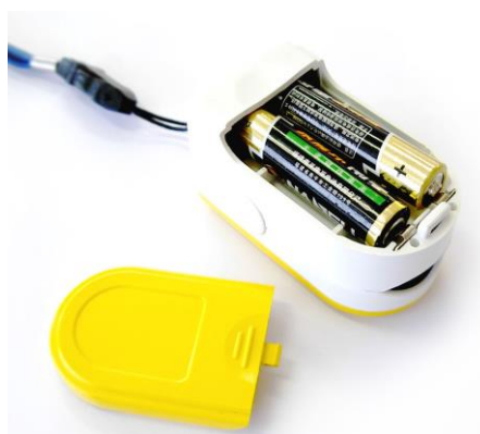
3. attēls bateriju uzstādīšana
